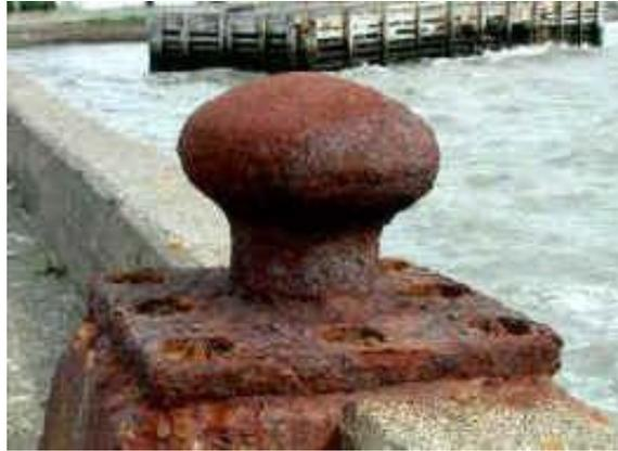
Figura 4.5.- Corrosión uniforme en el acero
