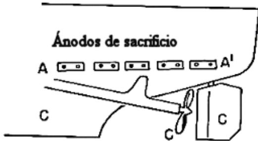
Figura 4.15.- Protección de un casco de barco utilizando ánodos de sacrificio
