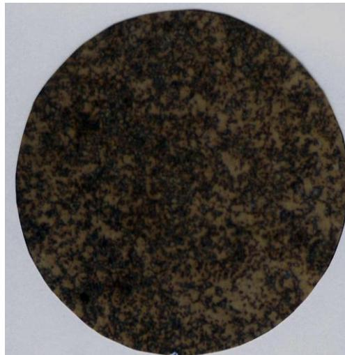
Figura 3.23.- Estructura esferoidizada de un acero con 1 % de C
